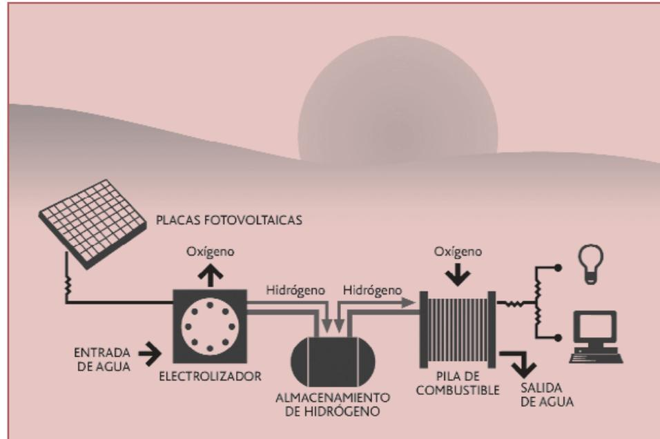
un sistema energético fotovoltaico, en la que el hidrógeno, como portador energético, puede jugar un papel importante.
