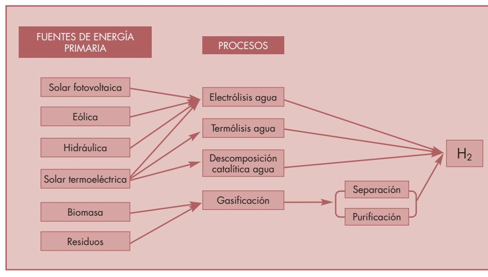
La electrólisis es un proceso electroquímico mediante el cual se genera hidrógeno y oxígeno a partir de la disociación del agua y energía eléctrica, transformándose la energía eléctrica en energía química. El equipo que lleva a cabo este proceso se denomina electrolizador. Cualquier fuente primaria que permita generar electricidad (fotovoltaica, eólica, hidráulica) es potencialmente una fuente de producción de hidrógeno a partir de electrólisis.
