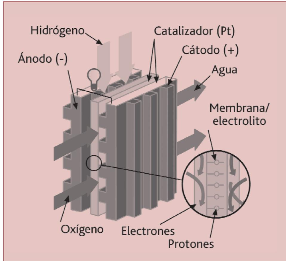
a los iones (electrolito). La reacción es electroquímica, no de combustión, por lo que no está sometida al límite de Termodinámica que marca el principio de Carnot. Por esa razón se pueden, teóricamente, alcanzar eficiencias eléctricas de hasta el 80%, frente al 40% para centrales térmicas convencionales y el 60% para ciclos combinados.
